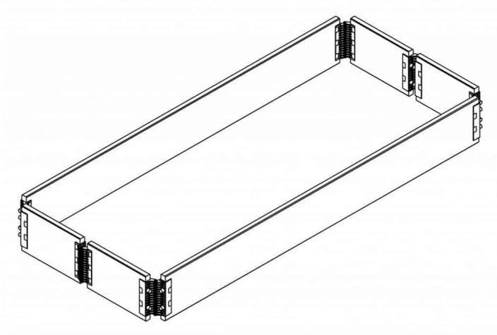
**HYMER FAHRGERÜST - BORDBRETT FALTBAR KURZ 707025**
