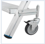
Vier bei Belastung arretierende Lenkrollen Ø 125 mm, davon zwei mit Feststellbremsen, gewährleisten leichtes Verschieben und verhindern ungewolltes Wegrollen beim Betreten der Treppe
