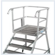
Plattformgröße 600 x 720 mm, Profilrost mit R13-Rutschhemmung
