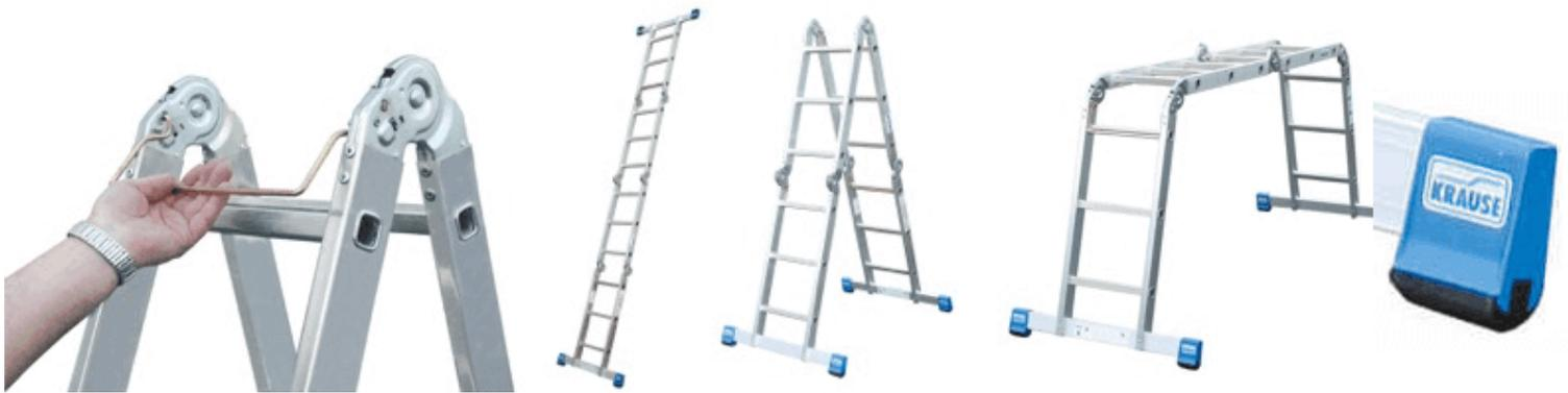
Der Hersteller Krause hat hier das patentierte SpeedMatic System verbaut. Hierbei handelt es sich um einen Einhand-Bedienhebel, der beide jeweils die Gelenke verbindet. Durch betätigen des Hebels werden direkt beide Gelenke bedient. Zusätzlich ist die Leiter mit den bekannten Leiterfüßen SaftyCap ausgestattet. Die Leiterfüße sind besonders sicher.
