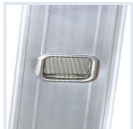
Langlebige, 32-fach verbördelte Sprossen-/Holmverbindung
