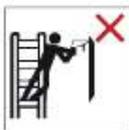
Vermeiden Sie Arbeiten, bei denen Leitern seitlich belastet werden, z. B. seitliches Bohren durch feste Materialien.
