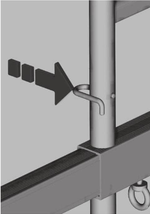
Hier im Bild dargestellt, sehen Sie die Sicherung mit Fallsteckern und die Ring-schraube des Schiebeteils.
