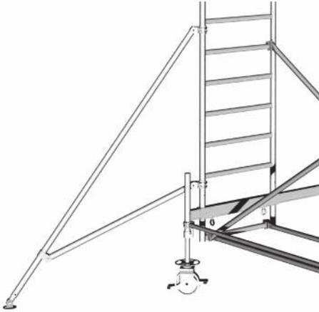
Montieren Sie die Ausleger wie im nebenstehenden Bild gezeigt. Die Befestigungskupplungen mit Halbschalen dienen der Verdrehsicherung und müssen mit einem Schraubenschlüssel SW 22 fest angezogen werden.
