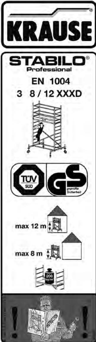
Das Typenschild ist an den Vertikalrahmen des STABILO-Systems angebracht.
