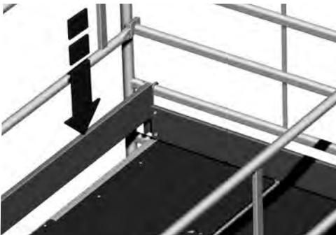
Setzen Sie die Längsbords ein (siehe Bild). Entfernen Sie nach der Montage der Bordbretter die Hilfsebenen (Schritt 6).
