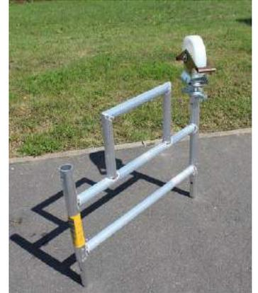
Die an der Spindelmutter angebrachte Flügelschraube wird nun in die am **Anfangs-Vertikalrahmen (5326)** vorgesehene Bohrung eingedreht. Hierdurch wird die **Fahrrolle (0052)** gegen unbeabsichtigtes Herausfallen gesichert. Nachdem die Rollen fixiert sind, drehen Sie den Anfangs-Vertikalrahmen wieder in die Gebrauchsstellung zurück.
