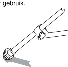
Uitzetpoot in gebruik: draaiknop in onderste positie vastzetten.
