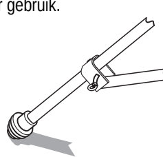
Uitzetpoot in gebruik: draaiknop in onderste positie vastzetten.
