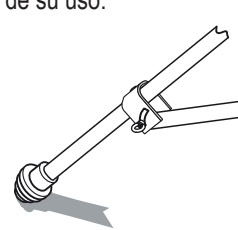
Estabilizadores en uso: Atornillar la tuerca en la posición abajo.
