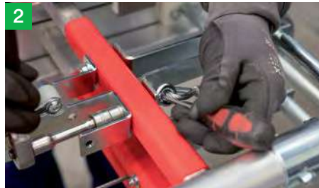
2 Schrauben der Umlenkrollenbefestigung entfernen.
