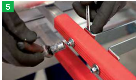
5 Seilbremse und Umlenkrollenbefestigung wieder festschrauben.
