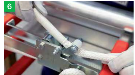
6 Seil einführen (siehe Tausch Zugseil) Hinweis: Vor Einsatz der Leiter unbedingt Funktionskontrolle durchführen – siehe Benutzerinformationen tragbare Feuerwehrlaternen.
