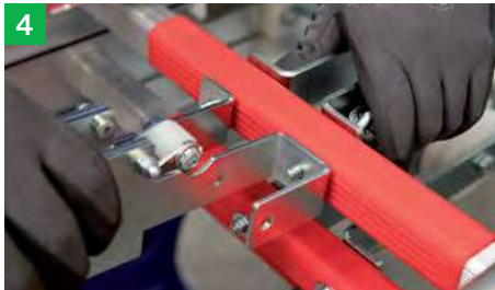
4 Neue Seilbremse einsetzen.
