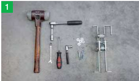
1 Hammer, Schlitzschraubendreher, U-Scheibe 6,4, Sechskantschraube 6 x50 und 6 x 45, Seilbremse komplett
