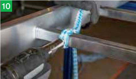
10 Mit Nietzange oder Blindnietsetzgerät vernieten
