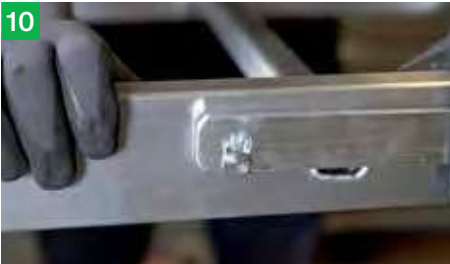
10 Starre Verbindung mit Arretierbolzen befestigen
