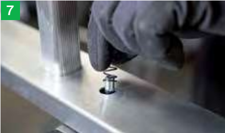
7 Feder aufsetzen und einschieben
