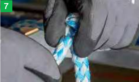
7 Verschleißtes Seilende in geweitete Öffnung einführen
