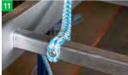
11 Fertig erneuertes Zugseil
