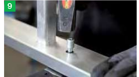
9 Mit dem Schlosserhammer aufschlagen
