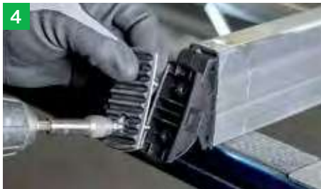
Neue Fußplatte mit Werkzeug montieren (Anzugsdrehmoment 2,5 Nm)
