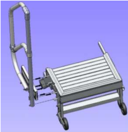
Vormontiertes Geländer anbringen
